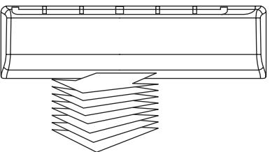
Регулируйте жалюзи горизонтального направления воздушного потока только при выключенных "автоколебаниях" (SWING), если Вы не уверены в своих действиях - выключите кондиционер, и, аккуратно провернув руками первую лопасть на удобный угол, без каких-либо усилий, установите требуемый угол для вертикальных жалюзи!
