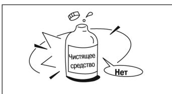
Не пользуйтесь для чистки кондиционера щелочными чистящими средствами. Под воздействием этих средств детали кондиционера (лоток для слива конденсата, теплообменник и т. д.) быстро разрушаются!
