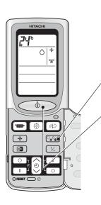
Нажимайте кнопку переключения РЕЖИМОВ РАБОТЫ до тех пор, пока на дисплее не появится символ ○ (ОСУШЕНИЕ). С помощью кнопки → (СКОРОСТЬ ВЕНТИЛЯТОРА) выберите НИЗКУЮ СКОРОСТЬ или МАЛОШУМНЫЙ режим работы вентилятора.
