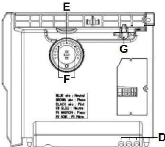
Щоб уникнути непередбаченої зміни настроювань, можна заблокувати або обмежити хід регулятора **C** й заблокувати бігунок **B**. Для цього, зніміть прилад з настінного кронштейна. На тильній стороні корпусу термостата, витягніть штифти **D**:
