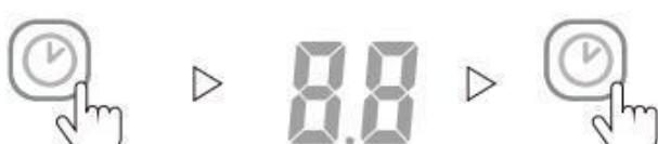
Нажмите кнопку «Таймер», индикатор синхронизации загорится зеленым, для установки необходимого времени работы в пределах 1-24 часа, а затем нажмайте кнопку «Таймер» до тех пор, пока на дисплее не появится 00. После восьми сек на дисплее отобразится текущая влажность и функция синхронизации будет отключена. По истечении заданного времени компрессор остановится автоматически.
