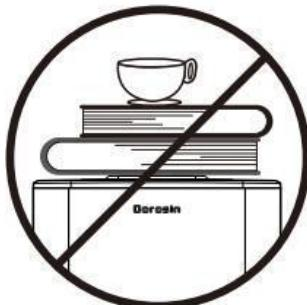
Поместите осушитель на устойчивую ровную поверхность. Если поверхность не ровная, это может повлиять на использование осушителя. Никогда не размещайте что-либо внутри или на поверхности осушителя.
