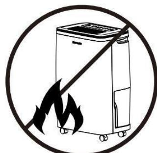
Запрещается хранить легковоспламеняющиеся и взрывоопасные вещества в местах, где используется осушитель. Утечки горючих и взрывоопасных веществ накапливаются вокруг компонентов и могут стать причиной случайного возгорания. Не устанавливайте осушитель рядом с источником тепла, так как это может привести к деформации или возгоранию.
