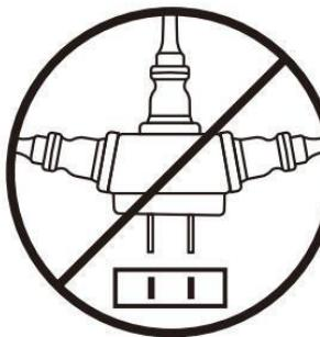
Запрещается заменять шнур питания или подключать кабель питания через переходники параллельно. Несанкционированная замена, промежуточное соединение, перегрузка могут привести к поражению электрическим током или пожару. Если шнур питания поврежден, обратитесь к местному дилеру или в сервисную сеть для ремонта. Несанкционированная разборка, модификация, ремонт или чистка внутренних компонентов запрещены.
