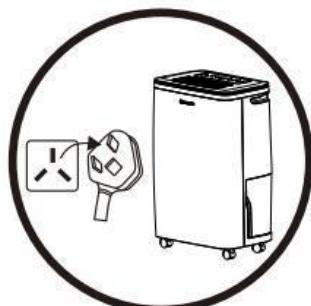
Не выключайте осушитель выдергиванием шнура питания. Отключение осушителя с помощью вилки питания может привести к поражению электрическим током, пожару и т. д. Всегда используйте панель управления, чтобы остановить работу осушителя. Обесточьте осушитель, если он не используется в течение длительного времени. Накопление пыли может привести к утечке, потере тепла, пожару и т. д. Обесточьте прибор, во избежание поражения электрическим током.
