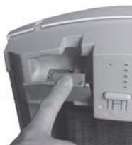
**2. Извлеките корпус датчиков и отключите соединительный шнур. Запомните положение соединительного шнура при отсоединении.**
