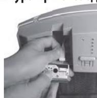
**3. С помощью отвертки отвинтите крышку корпуса датчиков. Откройте крышку.**
