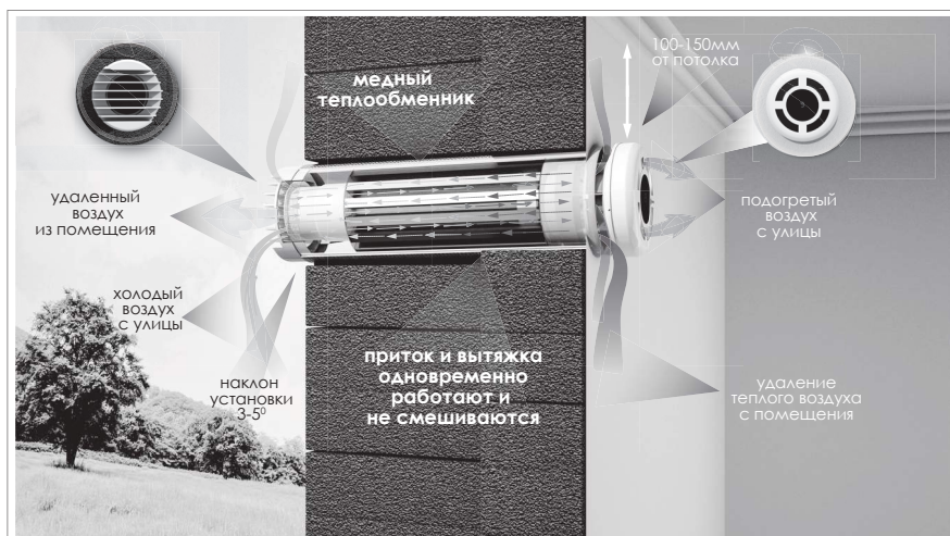
Рис.1. Принцип работы рекуператора PRANA-150, PRANA-200С, PRANA-200G
