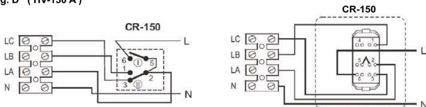
**ATENCIÓN:** Debe cambiarse el puente de los bornes 5-1 a 5-2.
