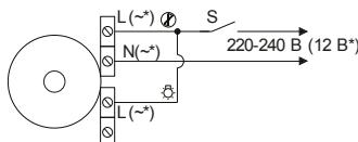
Схема подключения вентилятора Р и Р1, оснащенного таймером/таймером с датчиком влажности.
