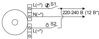
Схема подключения к сети вентилятора Хстар с одновременным включением вентилятора и встроенной лампы освещения.
