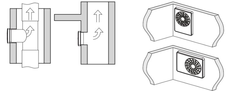
Монтаж может осуществляться с использованием сменного патрубка требуемого размера.
