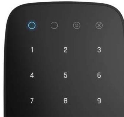
При пробудженні клавіатури загоряється світлодіод, який відображає поточний статус системи: під охороною / знято з-під охорони / нічний режим.
