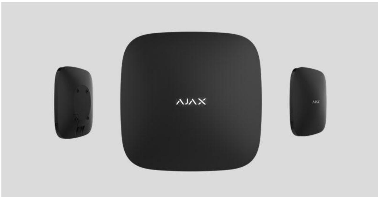
**Hub 2 Plus** – центральний пристрій у системі безпеки Ajax, який керує роботою всіх підключених пристроїв і взаємодіє з користувачем та охоронною компанією.
