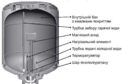
Рис. 1. ЕВАД ROUND в розрізі та його складові частини
