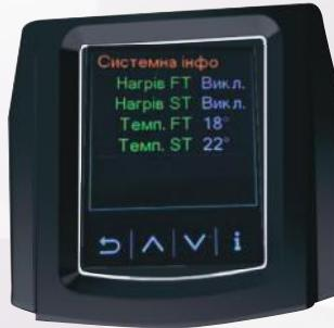
Системна інформація за допомогою якої Ви зможете відслідкувати актуальний стан роботи кожного із баків, роботи електричних тенів та температуру води в кожному з них.
