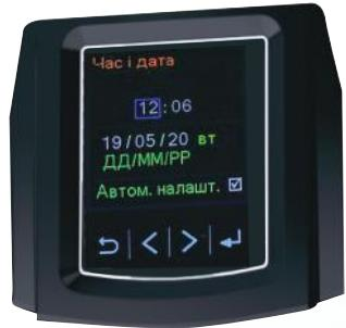
Налаштування дати та часу в системних налаштуваннях водонагрівача для подальшого відображення інформації на табло та коректної роботи електронного модуля керування.
