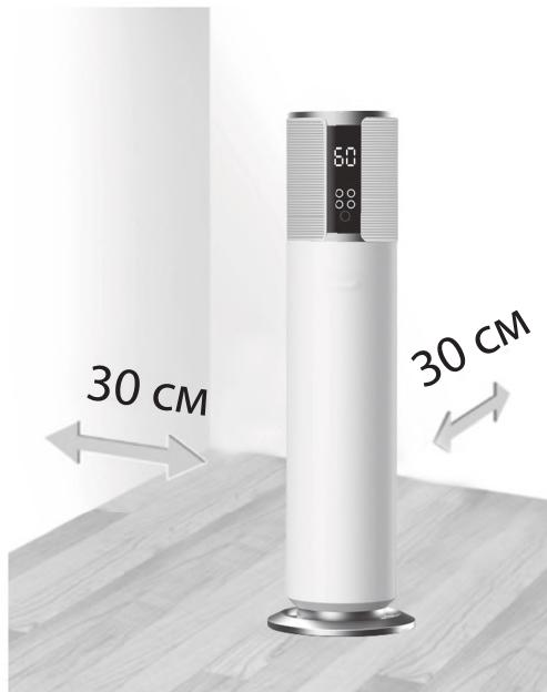
Встановлюйте зволожувач на відстані 30 см від стін і дерев'яних меблів.
