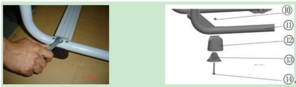
10-гайка, 11-опорна рама, 12-підставка, 13-ніжка підставки, 14-болт
