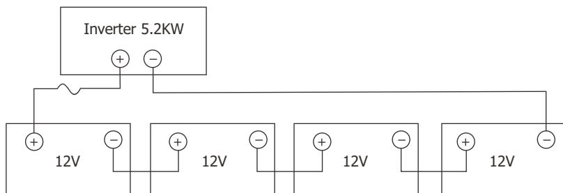
3. Плотно вставьте кольцевую клемму кабеля аккумулятора в разъем аккумулятора инвертора и убедитесь, что болты затянуты с моментом 2-3 Нм. Убедитесь, что полярность аккумулятора и инвертора подключена правильно, а кольцевые клеммы плотно прикручены к клеммам аккумулятора.
