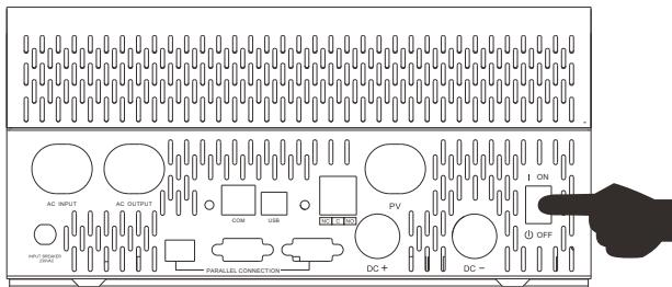
После того, как устройство было правильно установлено и батареи подключены правильно, просто нажмите переключатель включения / выключения (расположенный в нижней части корпуса), чтобы включить устройство.
